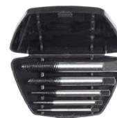
Cara frontal biselada para facilitar la inserción en la cabeza del tornillo, De acero al cromo-vanadio de alta aleación, Para tornillos con rosca derecha Para tornillos: M 3-6; M 6-8; M 8-11; M 11-14; M 14-18 diámetros: : 1,4-3,6; 2,1-4,9; 3,1-6,5; 4,8-8,8; 6,2-11 mm
