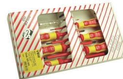
Transmisión óptima de la fuerza, Hojas de aceros especiales al cromo-vanadio de alta aleación, Resistente al aceite y los disolventes, Autorizado para máx. 1000 V CA y 1500 V CC, Mango de 2 componentes y diseño ergonómico para atornillar aplicando grandes fuerzas con poco esfuerzo, Termorresistente y apenas inflamable, 1 de cada: punta plana 2,5 x 75; 4,0 x 100; 5,5 x 125; 6,5 x 150 mm; PH 1 x 80; PH 2 x 100 mm, Comprobador de tensión 3 x 140 mm
